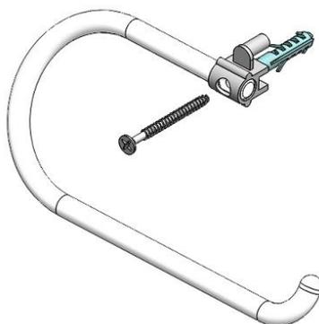
1.4. Terminada a fixação, recoloca a tampa frontal.
